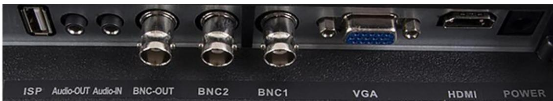
Назначение разъемов на задней панели монитора
